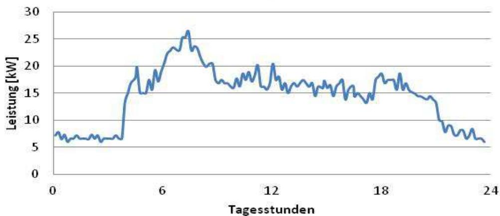
Aus den beiden oben dargestellten Abbildungen (Abbildung 7.5 und Abbildung 7.6) wird ersichtlich, dass die ganztägige Bandlast bzgl. der elektrischen Leistungsanforderung bei ca. 6 kW<sub>el</sub> liegt. Die Bandlast über die Tagesstunden (z.B. 08:00 – 19:00) jedoch fast durchwegs höher als 15 kW<sub>el</sub> liegt. Damit ergibt sich für die wirtschaftliche und ökologische Betrachtung der PV – Anlage eine Anlagenleistung von ca. 15 kW<sub>peak</sub>.
