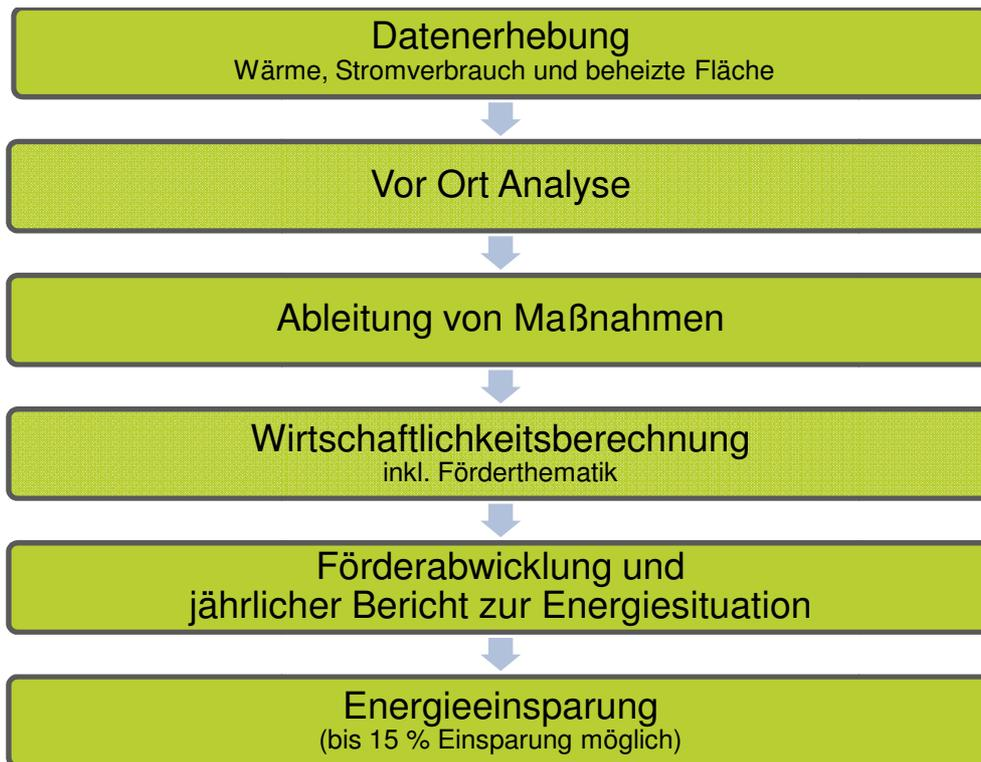
Abbildung 77 Flussdiagramm Objektanalyse ohne Sanierung [bero engineering, 2011]
