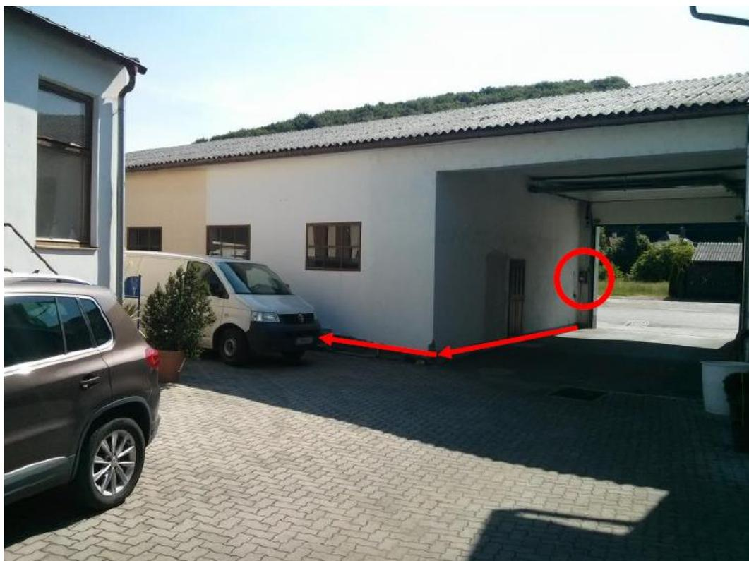
Innenhof des Gasthauses. Dort wo der Bus steht, würde das E-Fahrzeug dann stehen. Beim roten Kreis wäre das Starkstromkabel. Das Verlängerungskabel (rote Peile) müsste dann an der Mauer entlang verlegt werden. Wenn das Fahrzeug nur Wechselstrom braucht, könnte man auch ein Kabel bei den Fenstern rausgeben.
