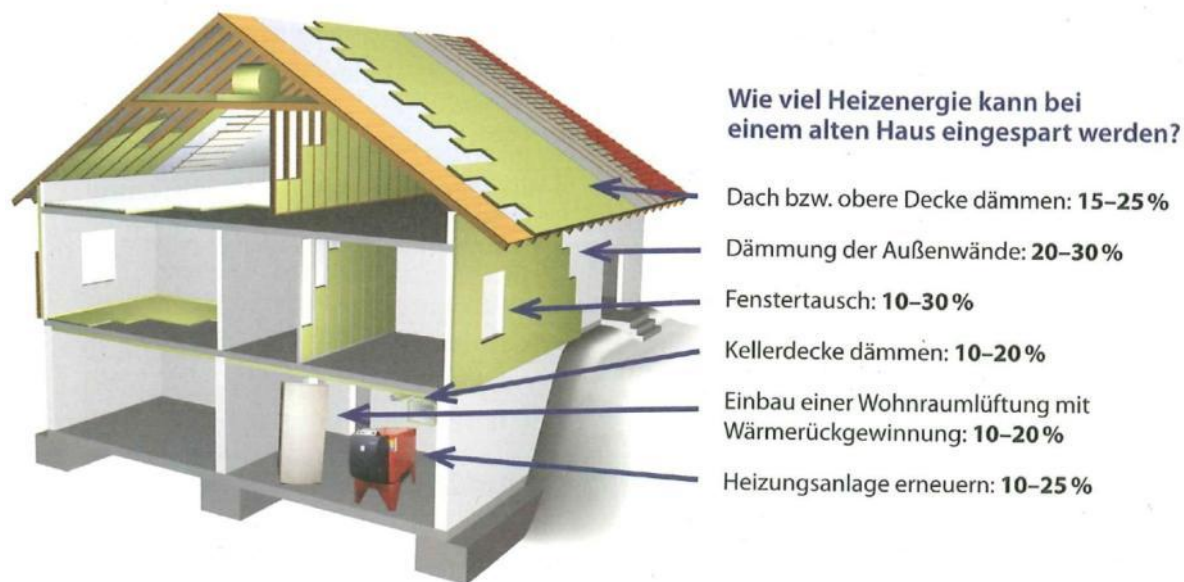
Abbildung 10: Einsparpotential Heizenergie bei verschiedenen Maßnahmen (Quelle: Energieberatung NÖ)
