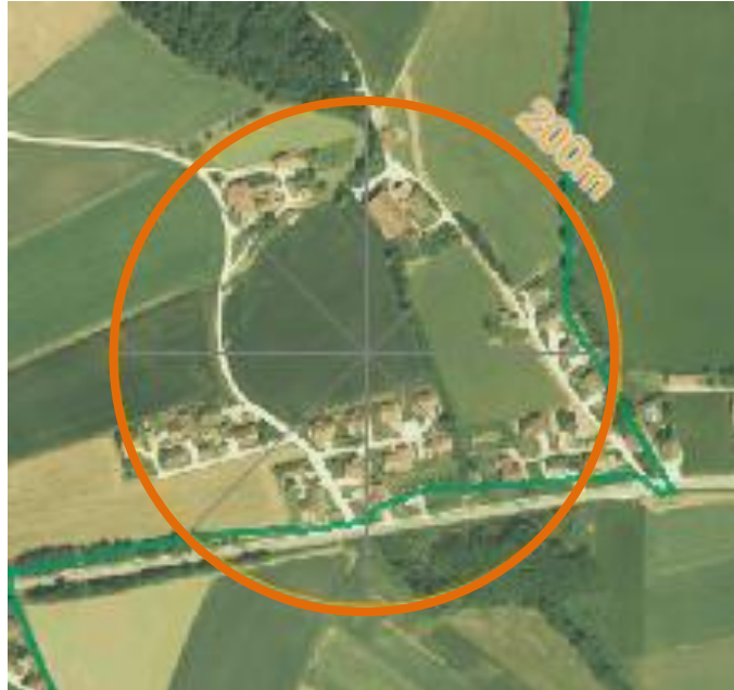
Abbildung 38: Möglicher Standort eines Mikrowärmenetzes in der Gemeinde Schachen bei Voral (Radius von 200 m)
