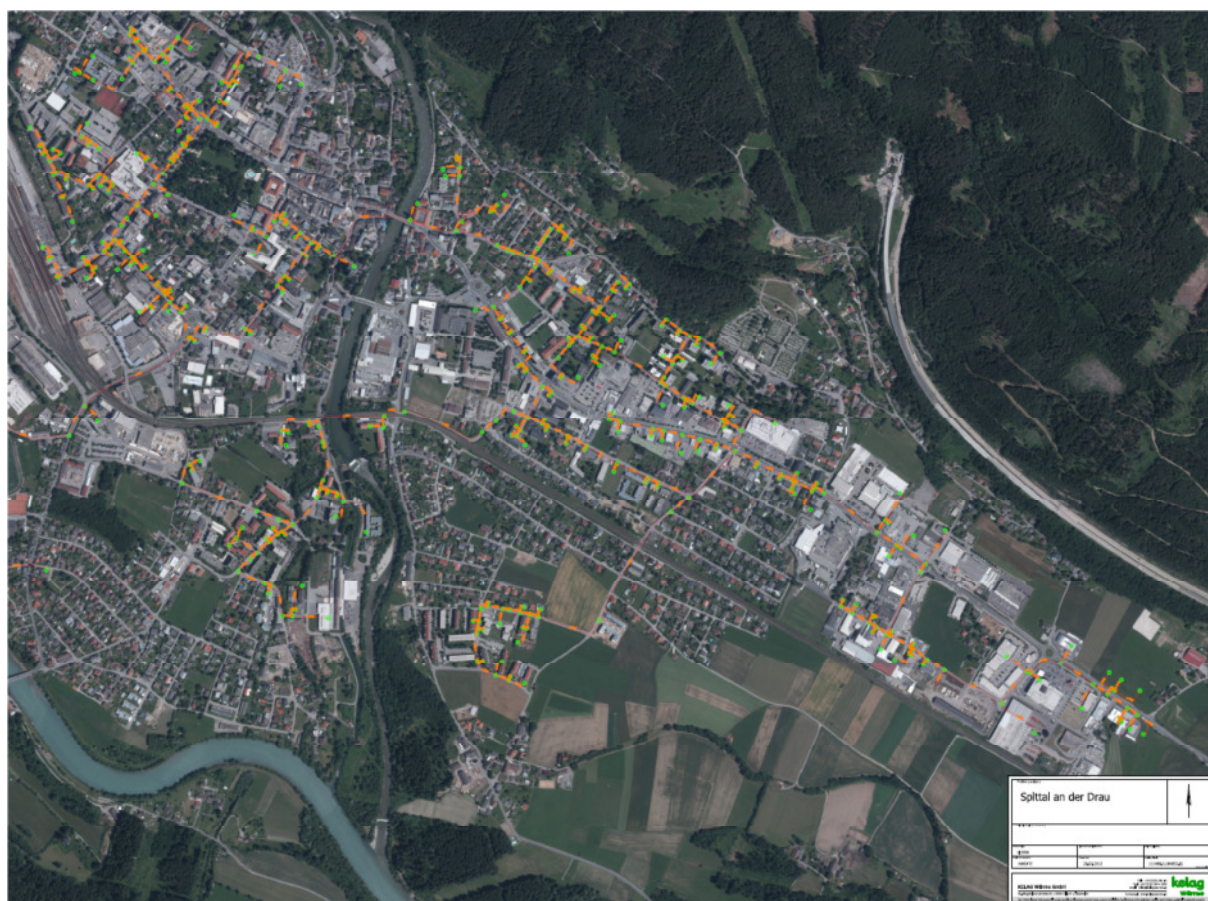
Abbildung 31: Geplante Trassenführung für die Implementierung des Fernwärmenetzes im Spittaler Stadtgebiet (Quelle: KELAG Wärme GmbH, 28.02.2012)
