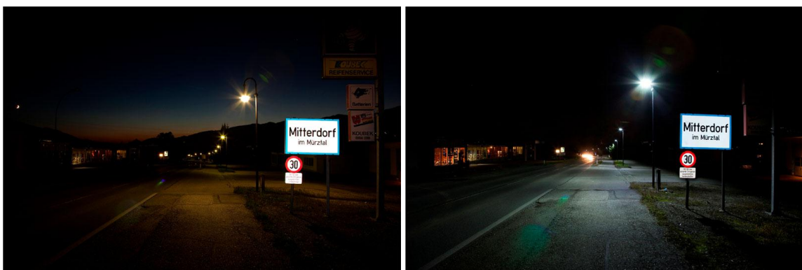
Abbildung 19: Straßenbeleuchtung in Mitterdorf im Mürztal im Vergleich | links: alte Quecksilberdampflampen, rechts: neue LED-Lampen (Bildquellen: www.led-europameister.at)
