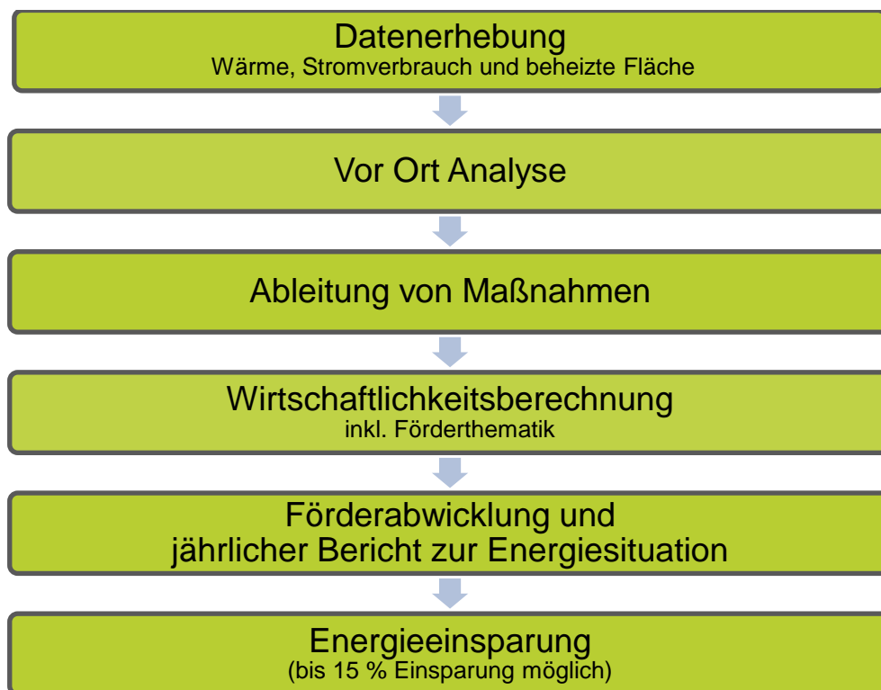
Abbildung 49: Flussdiagramm Objektanalyse ohne Sanierung [bero engineering, 2010]
