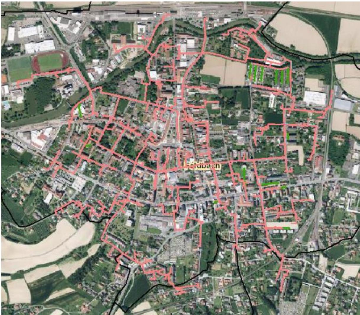
Abbildung 1: Überblick Fernwärmenetz Feldbach
