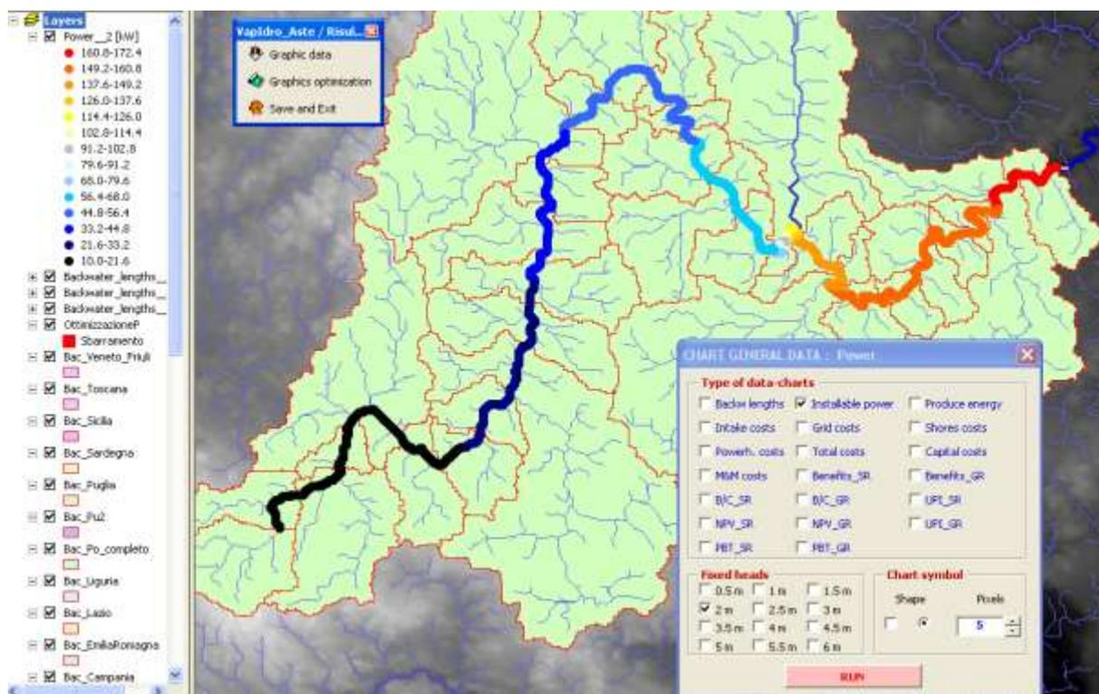
Abb. 36: Energiepotential der Thaya (Modellierung: Projekt SMART)
